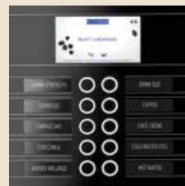
Kapacitivt keypad med 10 valgtaster og et multifarvedisplay på 4.3" med RSS feed gør det sjovt at vælge sin drik, mens der vises billeder og videoklip.
